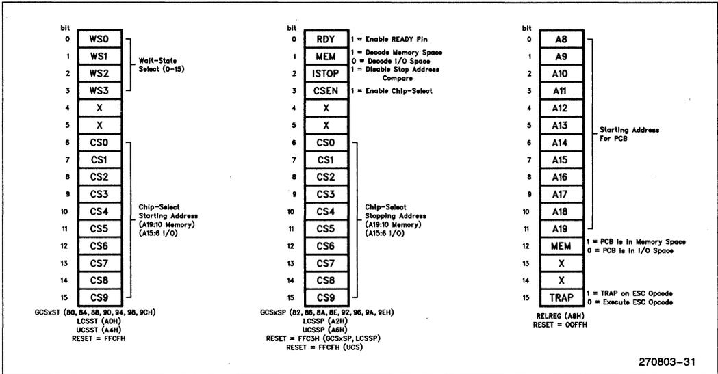
Figure 29. Chip-Select Unit Registers
