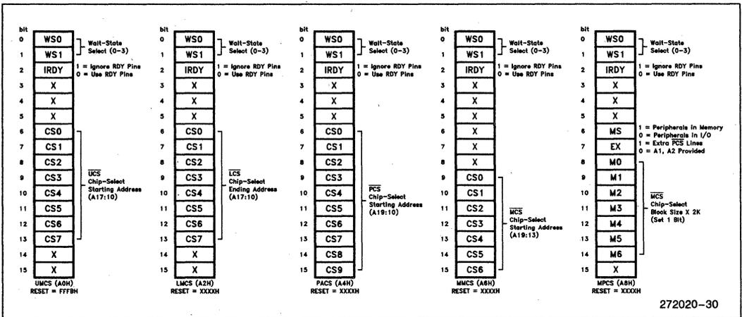
Figure 27. Chip-Select Unit Registers
