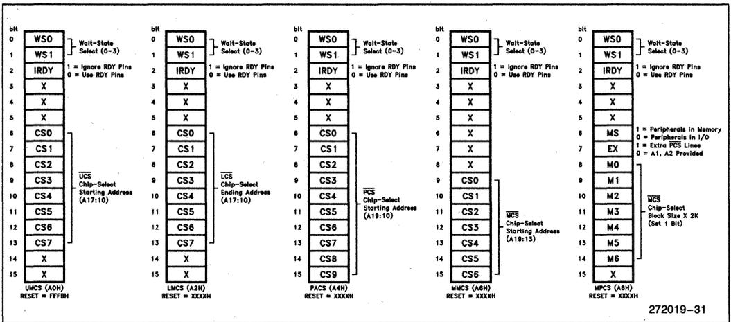
Figure 27. Chip-Select Unit Registers
