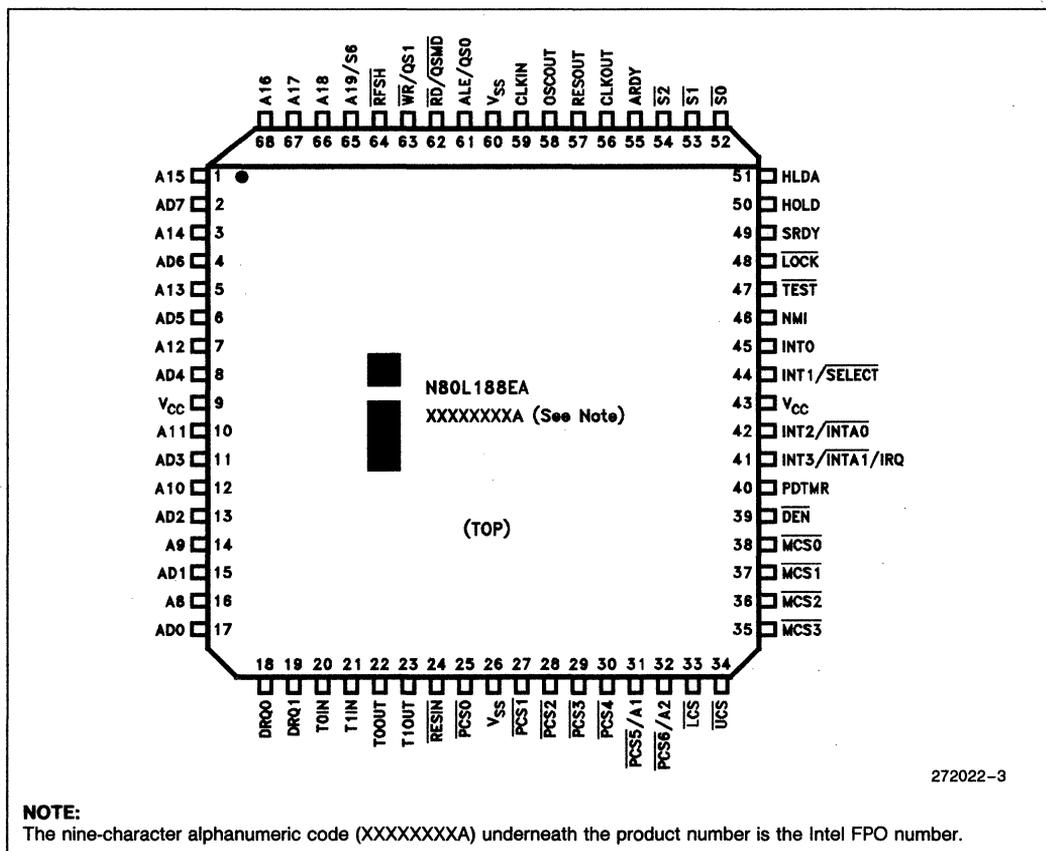
**Figure 2. 68-Lead PLCC Pinout Diagram**
