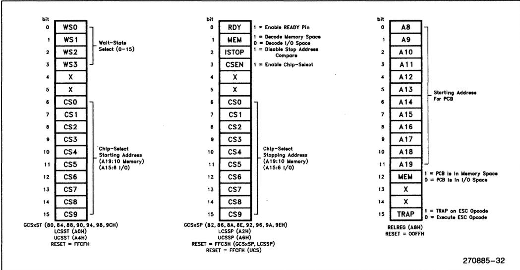
Figure 29. Chip-Select Unit Registers
