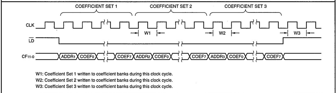
**FIGURE 7. CONFIGURATION/CONTROL REGISTER LOADING SEQUENCE**
