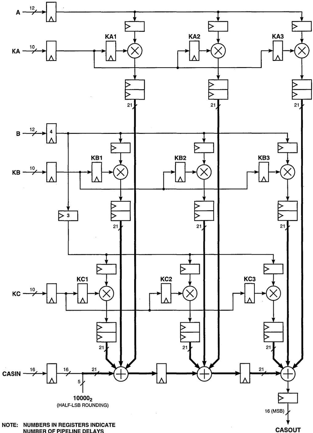
**FIGURE 4. 3 x 3-PIXEL CONVOLVER — MODE 10**
