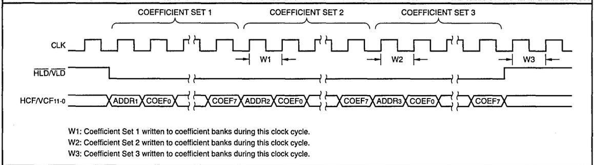
**FIGURE 13. CONFIGURATION/CONTROL REGISTER LOADING SEQUENCE**
