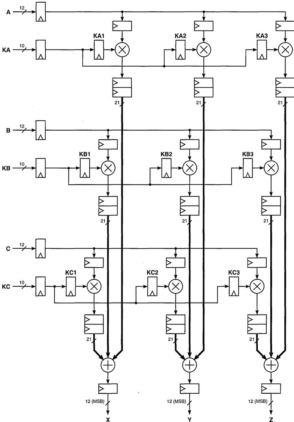
**FIGURE 3. 9-TAP FIR FILTER — MODE 01**
