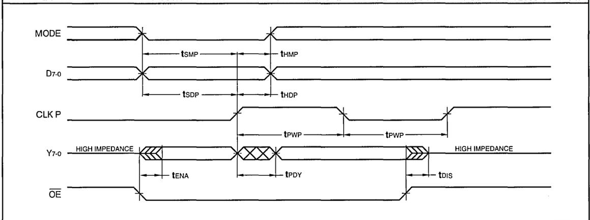
**SWITCHING CHARACTERISTICS — SERIAL SHIFT OPERATION**
