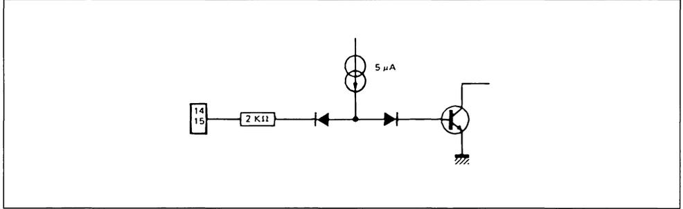
**PIN 13 : GROUND****PIN 14-15 : GAIN ADJUSTMENT INPUTS**
