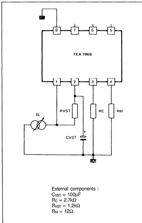
Figure 2 : Impedance Measurement.
