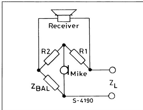
Figure 1 : Test Circuit.
